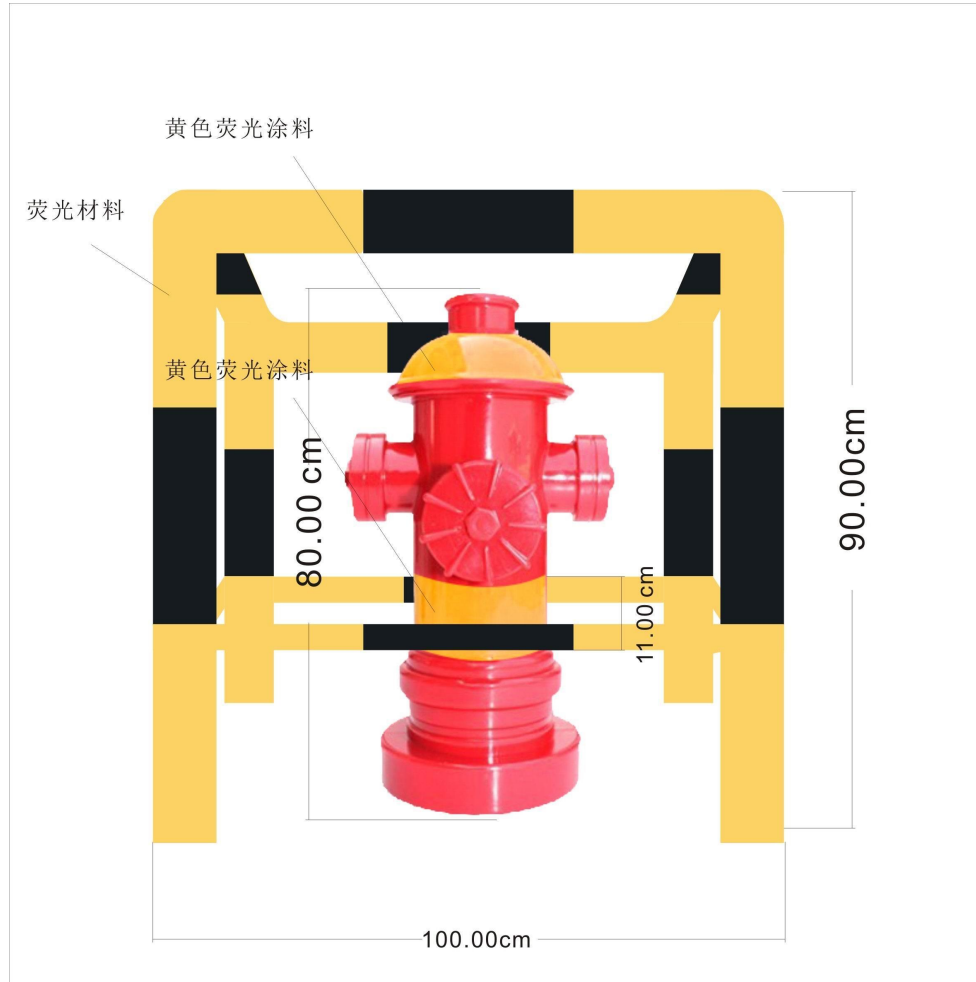
图 E.1.1 消火栓防撞栏
